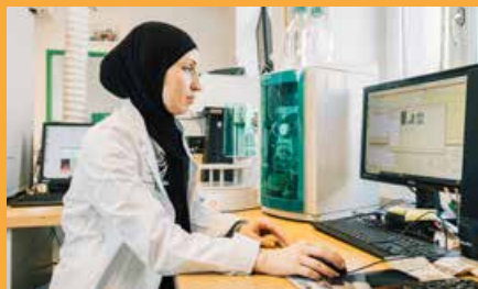
Mittels Ionenchromatographie testet sie, welche Stoffe in den Pellets enthalten sind. Grenzwerte dürfen nicht überschritten werden.
