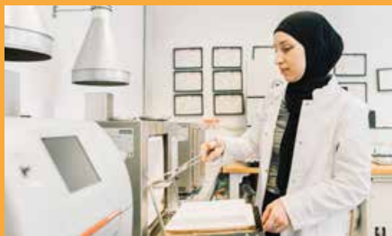
Statt Hilfsjobberin ist Aischat Achmaew jetzt Labortechnikerin und testet etwa Holzpellets. Hier macht sie aus gemahlenden Pellets Asche.
