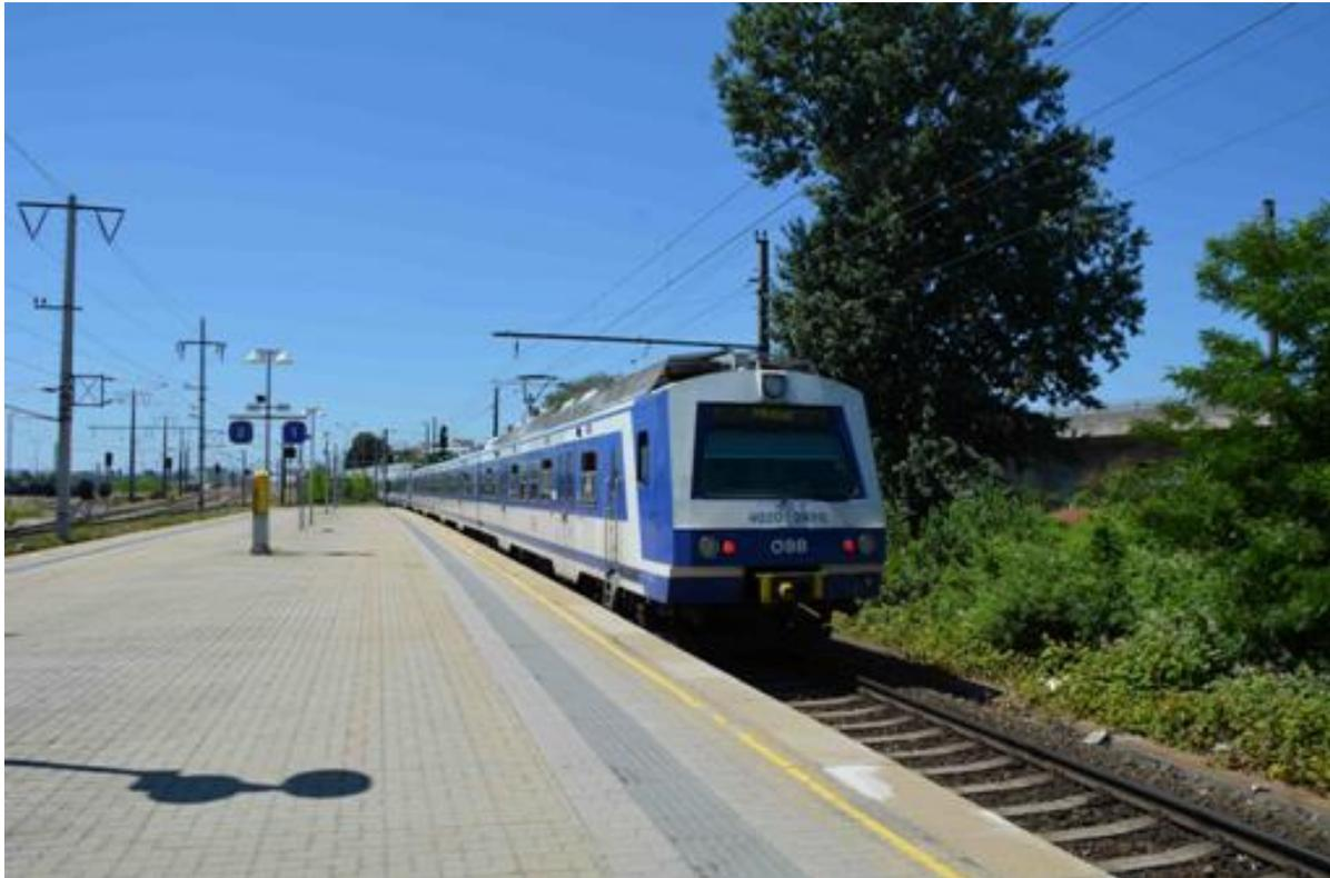
Die 1978 bis 1987 in einer Zahl von 120 Stück beschaffte, dreiteilige Triebwagenreihe des Typs 4020 bildet – meist in Doppeltraktion – nach wie vor das Rückgrat der Wiener S-Bahn. Es war dies das letzte S-Bahn-Produkt aus rein österreichischer Produktion (Fa. SGP). Bei den Hauptausbesserungen ab 1993 erfolgten Modernisierungen, insbesondere mit einer verbesserten Innenausstattung, Türraumüberwachung und Zielanzeigen.
