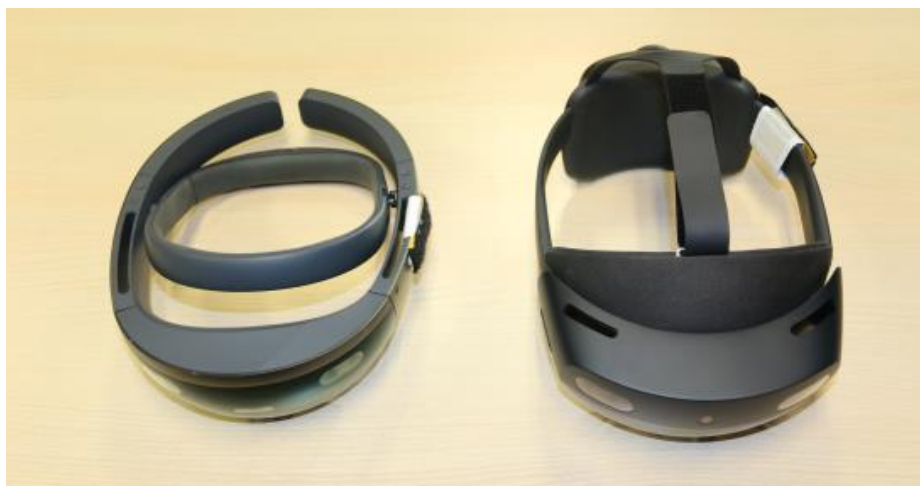
Abbildung 9: Veranschaulichung der Befestigungen - HoloLens 1 (links) vs. HoloLens 2 (rechts).
