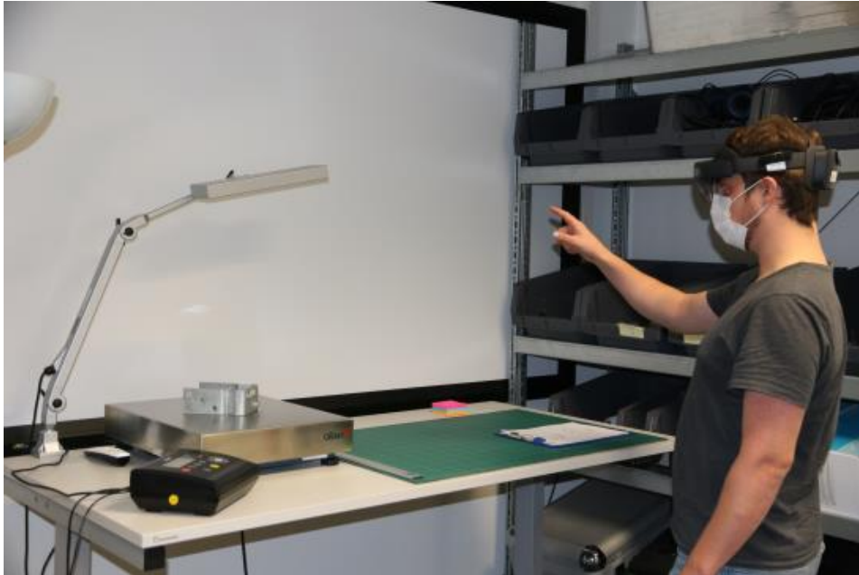
Abbildung 10: Interaktion mit der HoloLens 2 an der höhenverstellbaren Werkbank, mit Waage und Schiebelehre. Die Bauteile befanden sich im Kanban-Regal rechts.
