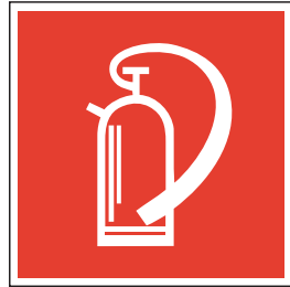
Hinweis auf ein Feuerlöschgerät
