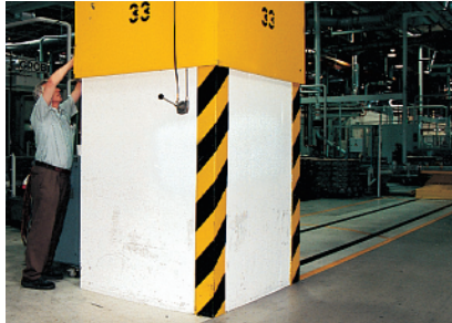
Sicherheitsfarben „Kennzeichnung von Hindernissen und Gefahrenstellen“
